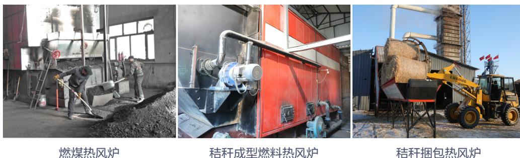
图 4-1: 东北地区不同燃料类型的粮食烘干塔热风炉
