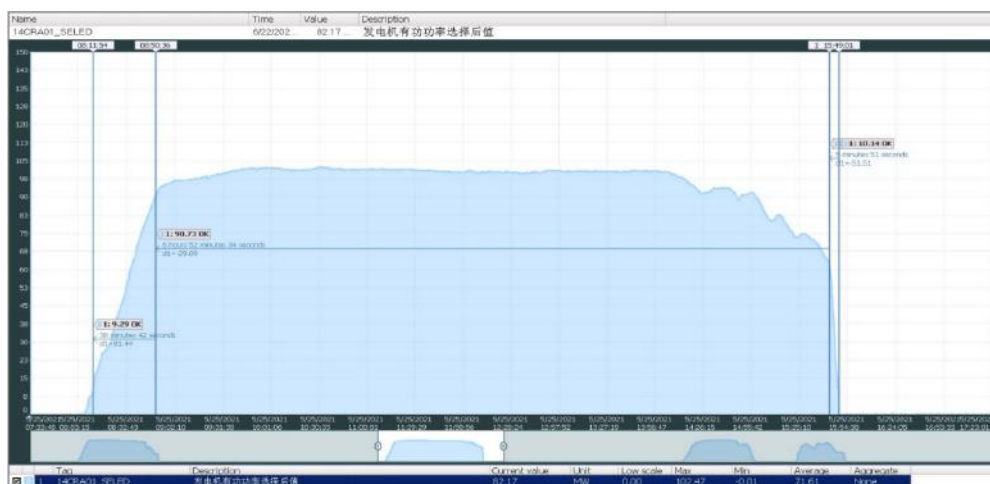
图：机组升降负荷速率最高可达 10 MW/min（常规调峰电站爬坡速率 2%/min~5%/min）
