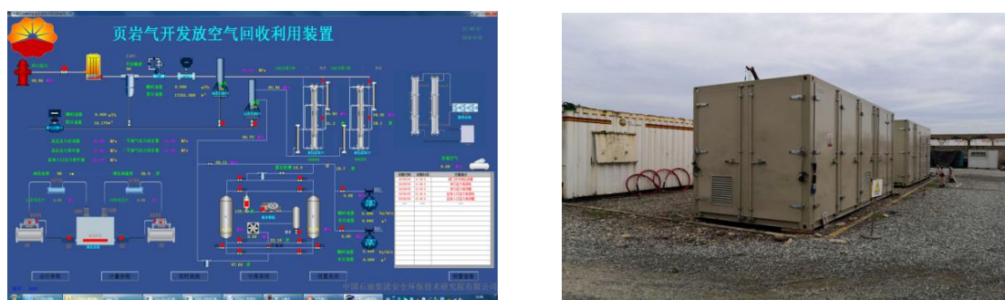
图 3-3 页岩气开发放空空气回收利用装置操作界面及装置图
